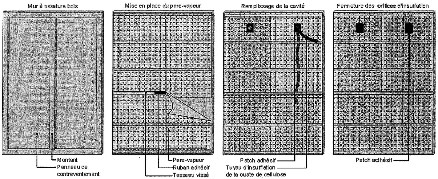
**Figure 2 : UniverCell® Confort Vrac insufflé derrière un pare-vapeur**
